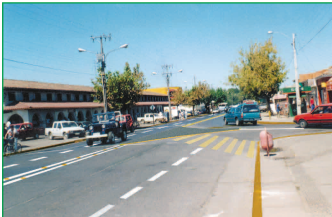
Isla canaliza los movimientos vehiculares y mejora percepción de la operación de la intersección. Peatones pueden cruzar en dos etapas asistidos por la isla.
