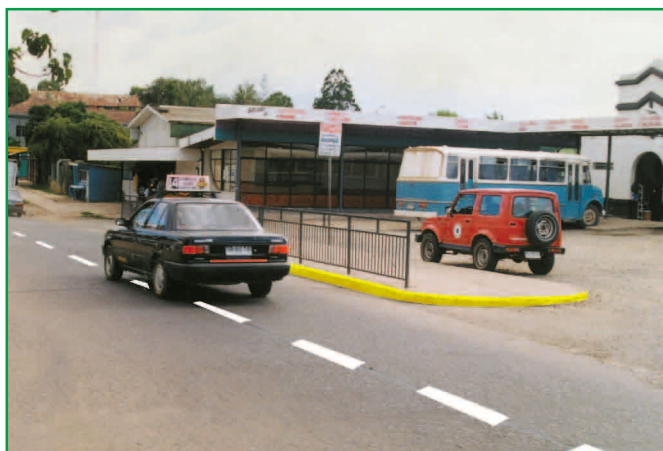
Se traslada la parada de colectivos y se elimina el kiosco, quedando la acera solamente para circular. Vallas canalizan a peatones.
