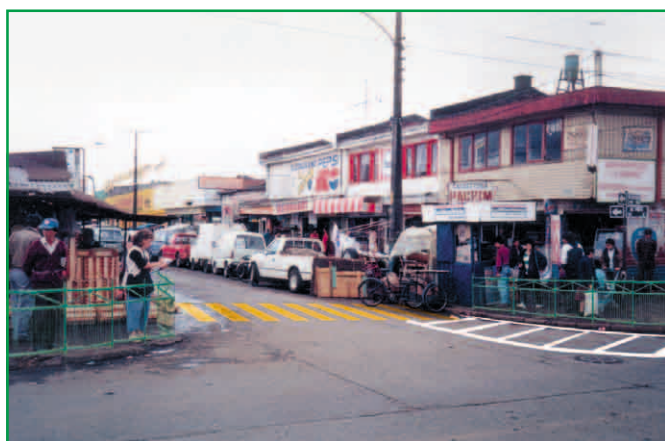
Extensiones de acera y vallas mejoran condiciones de seguridad para cruce de peatones.
