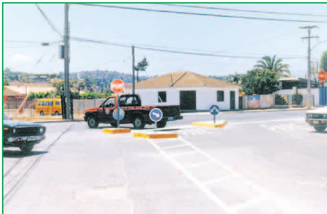
Mediana fantasma e islas canalizan los diferentes movimientos vehiculares reduciendo los conflictos
