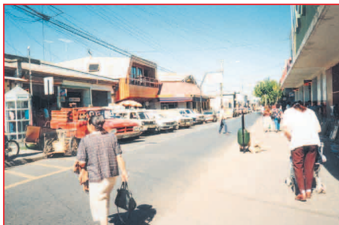
En las proximidades de la intersección, vehículos se estacionan en ángulo generando conflictos a los vehículos que circulan y a peatones. Locomoción colectiva se detiene a lo largo de este tramo
