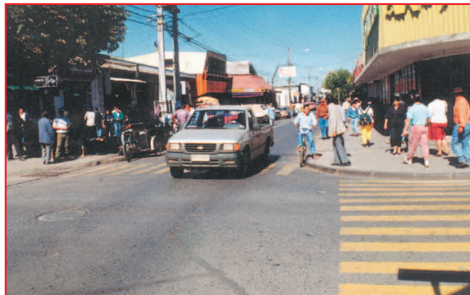
En esta intersección faltan elementos que den mayor seguridad al cruce de peatones, especialmente canalización hacia lugares de menor riesgo
