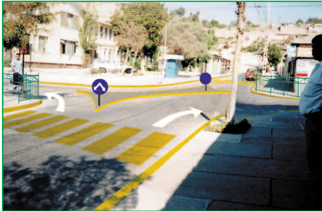
Simple solución: una isla canalizadora logra articular los movimientos vehiculares sin necesidad de proveer señales de prioridad
