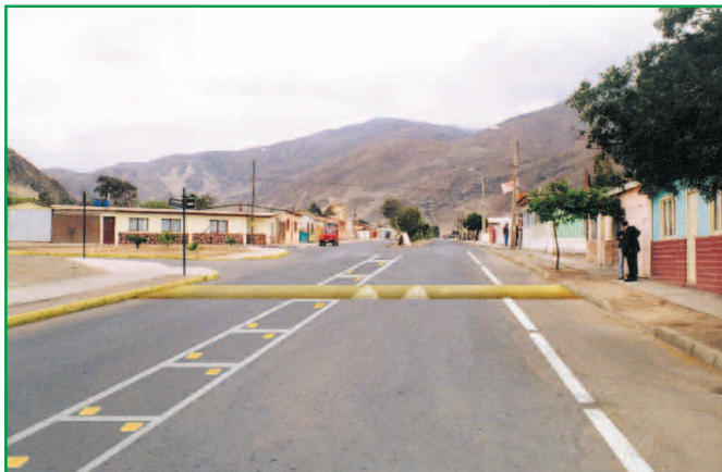
Mediana fantasma separa los flujos (además de dar continuidad a mediana de tramo precedente) angosta la vía y por lo tanto calma la velocidad. También se instalan lomos de toro. Peatones pueden cruzar en dos etapas
