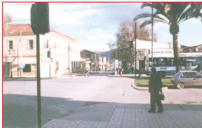
Esta intersección es confusa tanto para conductores como para peatones puesto que en ella está el acceso a la estación de trenes (izquierda), el cual puede percibirse como continuación de la vía. No existen facilidades claras par el cruce y circulación de peatones
