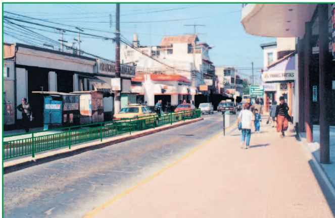
Se segrega paso y detención de locomoción colectiva del resto del tráfico. Vallas impiden cruce indiscriminado de peatones
