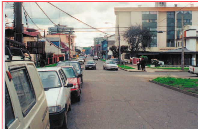
En esta intersección, vehículos estacionados obstaculizan la visibilidad de vehículos y de peatones. Además la intersección tiene poca notoriedad
