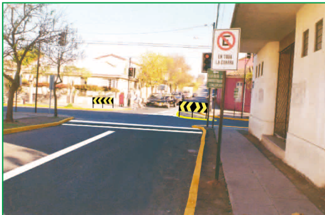
Se provee una isla canalizadora de modo que conductores "lean" claramente funcionamiento de las vías. Señales y demarcaciones apoyan información al conductor. Vallas canalizan peatones
