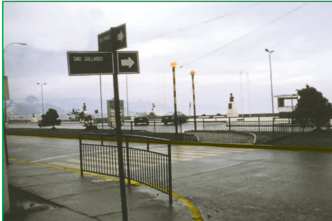
Se elimina el estacionamiento de vehículos en las proximidades de la esquina. Se provee un cruce cebra retirado de la esquina y reforzado con balizas.
