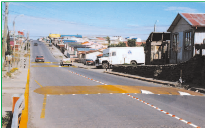
Lomos de toro calman la velocidad al acercarse a la intersección. Topes realzan la existencia de la intersección (vía de tierra, pero muy usada)
