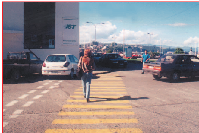
Vehículos estacionados hasta la esquina obstaculizan la visibilidad de peatones que cruzan y de vehículos que emergen desde vía menor. No existen facilidades formales para el cruce de peatones.
