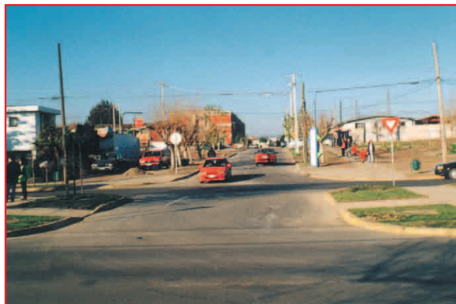
Tramo que cruza la mediana es de doble sentido y se generan conflictos entre vehículos que esperan y aquellos que viran desde vía principal, y de éstos con peatones
