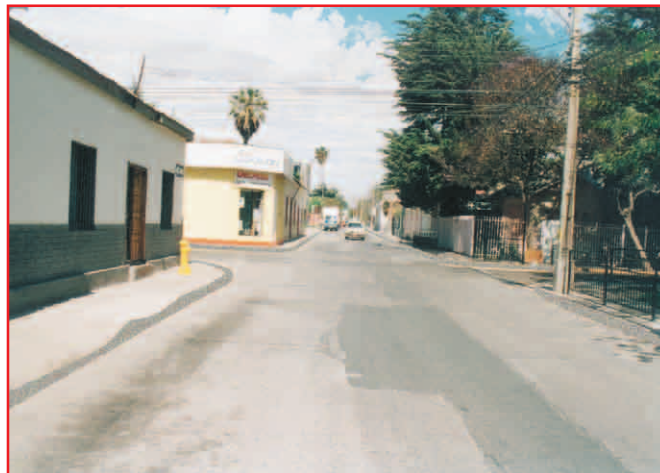
Mala visibilidad desde vía menor. Falta de brechas seguras por exceso de velocidad en vía principal pues es una vía larga y recta. No existen facilidades seguras para el cruce de peatones
