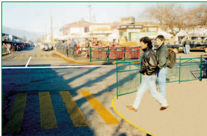
Vallas canalizan a peatones hacia las aceras y evitan instalación de puestos de feria. Se proveen cruces en lugares de menor riesgo
