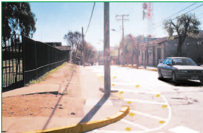
"Extensión de acera" (angostamiento de vía) en vía principal permite que vehículos de vía menor puedan tener mejor visibilidad; también calma velocidad de vehículos en vía principal
