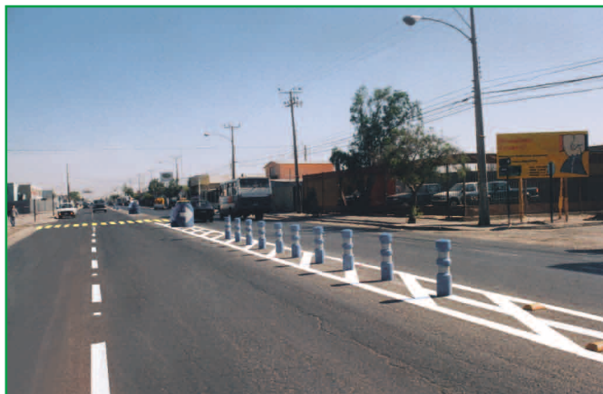
Mediana permite que peatones puedan cruzar en dos etapas al contar con espacio protegido con elementos adicionales
