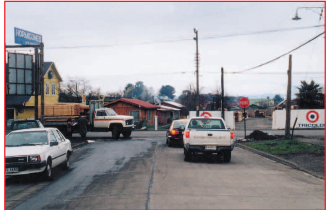
Intersección con conflictos por múltiples virajes hacia la izquierda. Exceso de velocidad en vía principal (vía de acceso a la ciudad) y falta de brechas para vehículos de vía menor
