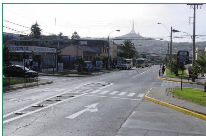
Se provee mediana fantasma la cual angosta las pistas calmando las velocidades; además permite la habilitación de pista para los virajes hacia la izquierda.
