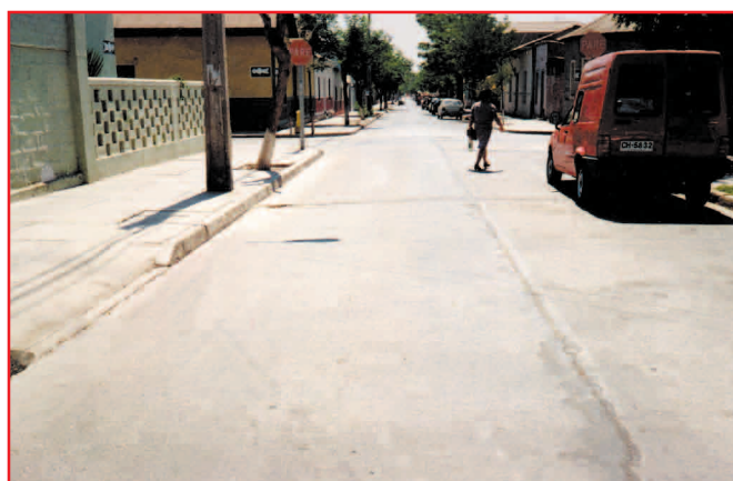
Vía larga y recta incentiva la velocidad; los vehículos estacionados a un costado entorpecen la notoriedad de la intersección con la vía menor. Peatones cruzan entre vehículos
