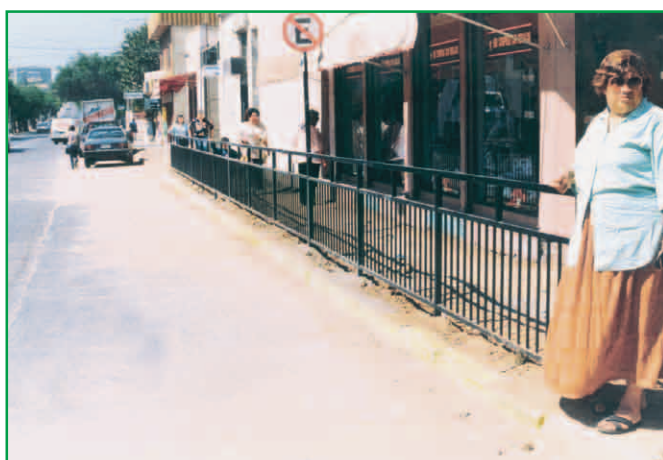
Vallas peatonales impiden cruces peatonales en lugares riesgosos
